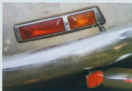
Zwei Raritäten, die meist Nachfertigungen weichen mussten: Rücklichtdichtung in Grau statt Schwarz, Katzenauge aus Glas
