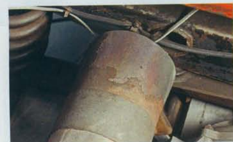
Anerkannte Restaurierungs-Philosophie: Ergänzungen wie hier am Schalldämpfer sind deutlich vom Original zu unterscheiden
