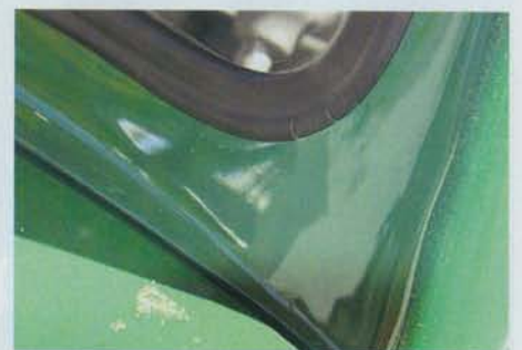
Kaum zu sehen: Der Lack dieses Tempo wurde in den Werkstätten des Deutschen Museums mit Wachs restauriert
