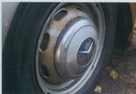
Heute besitzt kaum mehr ein Flügeltürer die zweifarbenen Radkappen, wie sie nur bei den ersten Exemplaren verwendet wurden
