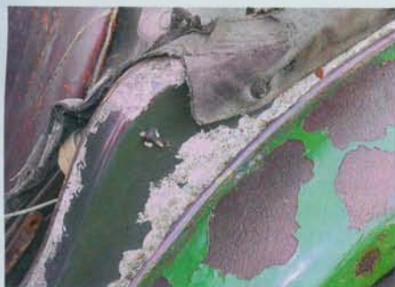
Während die Kotflügel einst eine neue Pinsellackierung erhielten, trägt die Karosserie noch den dunkleren Originallack
