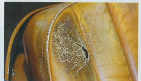
Typischer Museumsschaden: Das Leder des Mercedes SS im Deutschen Museum wurde so oft angefasst, bis es brüchig wurde
